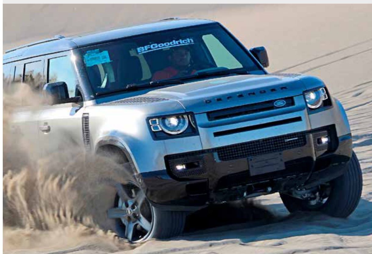
Cuenta con tracción en las 4 ruedas, así como sistema de bloqueo diferencial trasero y delantero automático.
