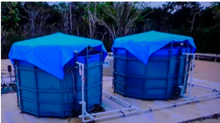
■ Planta piloto que genera biogás con sargazo y lodos residuales.
