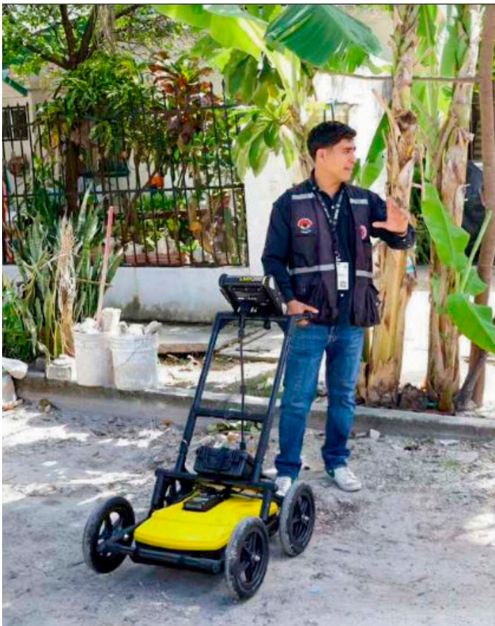
■ El georradar de la Dirección de Protección Civil ha permitido detectar entre 10 y 15 puntos de riesgos de hundimientos.
